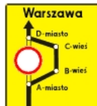
F-8 objazd w związku z zamknięciem drogi
