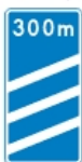
F-14a tablica wskaźnikowa na autostradzie umieszczona w odległości 300 m przed pasem wyłaczania
